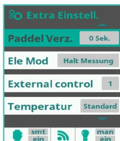
Im Menüpunkt „Paddel Verz.“ kann eine Zeit von 0 – 60 Sek. zur Verzögerung der Auslösung des Flow-Alarm FL1 eingestellt werden. Dadurch können Fehlansprechungen durch kurzes, systembedingtes Ansprechen des externen Paddelschalter oder des Gas-Sensors vermieden werden.
