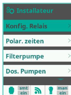
Um in das **Installateur**-Menü zu gelangen, muss der Sicherheitscode eingegeben werden. Detaillierte Informationen zum Sicherheitscode können in der Hauptanleitung nachgelesen werden.
