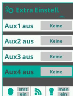
Hier kann für die Relais Aux1 bis Aux4 festgelegt werden, ob das Einschalten des jeweiligen Relais durch das Auftreten der Alarme FL1 und/oder FL2 unterbrochen wird.
