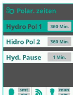
Definiert die Zyklendauer, für die die Chlorerzeugungszelle in den Polaritäten 1 & 2 (**Hydro Pol1 und Hydro Pol2**) läuft. Obwohl eine getrennte Einstellung möglich ist, empfiehlt es sich die Zyklen für beide Polaritäten gleich einzustellen.
